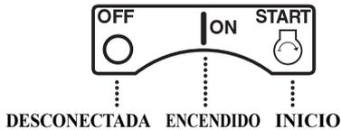
4. Gire la llave del interruptor del motor a la posición START y reténgala ahí hasta que se ponga en marcha el motor. Cuando el motor se ponga en marcha, suelte la llave dejándola que retorne a la posición ON.
