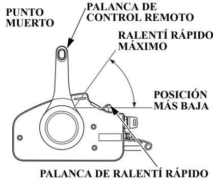
La palanca de ralentí rápido no se moverá a menos que la palanca de control remoto esté en la posición de PUNTO MUERTO. Por el contrario, la palanca de control remoto no se moverá a menos que la palanca de ralentí rápido esté en la posición más baja.
