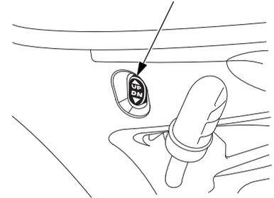
Cuando esté alejado del interruptor de trimado/inclinación motorizados de la palanca de control o del lado de la caña del timón, podrá operar el interruptor de inclinación motorizada del lado del motor fueraborda.
