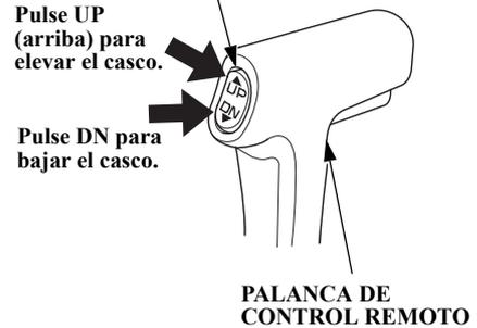
El sistema de trimado/inclinación motorizados opera cuando se presiona el interruptor, y se para cuando se suelta el interruptor. Para trimar un poco hacia arriba, presione UP (arriba) momentáneamente pero con seguridad. Para trimar hacia abajo ligeramente, presione en la porción DN (abajo) de la misma manera.
