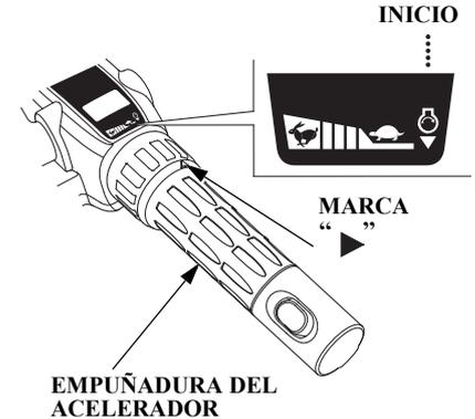
3. Alinee la marca "
