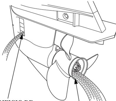
ORIFICIO DE SUCCIÓN DEL AGUA DE ENFRIAMIENTO
