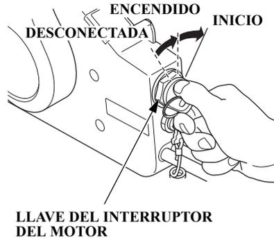
4. Gire la llave del interruptor del motor a la posición de arranque START y manténgala allí hasta que el motor arranque. Cuando el motor arranque, suelte la llave dejándola volver a la posición ON.
