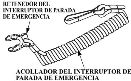
El cable del interruptor de parada de emergencia se incorpora para detener inmediatamente el motor cuando el operador se cae por la borda o lejos del motor fueraborda.
