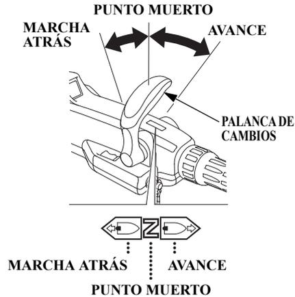
Utilice la palanca de cambios para hacer marchar la embarcación hacia adelante o hacia atrás, o para cortar la potencia del motor a la hélice. La palanca de cambios tiene tres posiciones.
