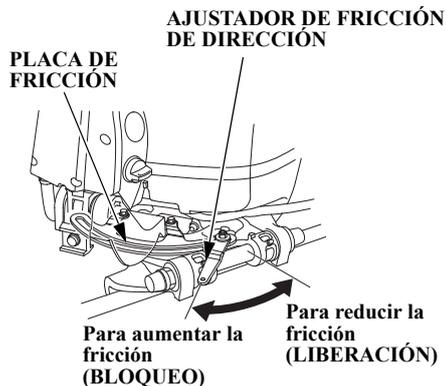
Compruebe si la caña se mueve bien. Para poder controlar con suavidad el rumbo, ajuste el ajustador de la fricción del timón de modo que note un poco de arrastre al efectuar giros.
