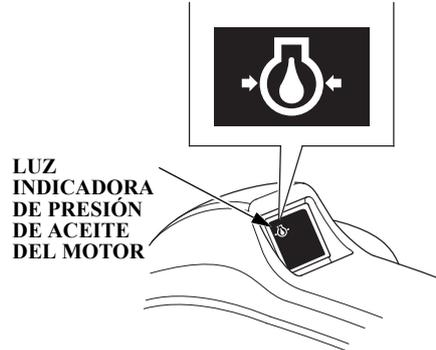
6. Compruebe si se enciende la luz indicadora de la presión del aceite. Si no se enciende, pare el motor y efectúe las inspecciones siguientes.
