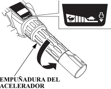
Gire la empuñadura a la izquierda o a la derecha para ajustar el régimen del motor. Al girar la empuñadura en la dirección de la flecha se incrementa el régimen del motor.
