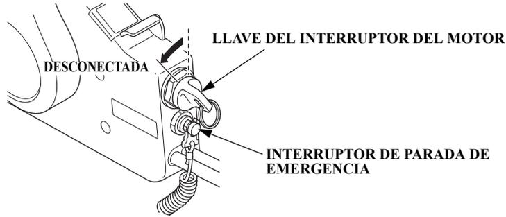
2. Gire la llave del interruptor del motor a la posición OFF para parar el motor.
