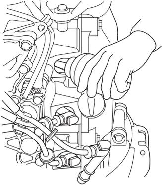
5. Introduzca una cucharada de aceite de motor en el orificio de cada bujía, y tire varias veces de la cuerda de arranque de emergencia para lubricar el interior de los cilindros.
