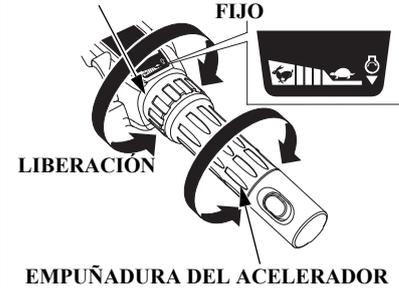
El ajustador de la fricción del acelerador ajusta la resistencia a la rotación de la empuñadura del acelerador.
