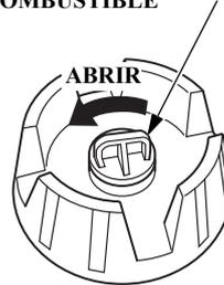
3. Gire la perilla de ventilación de la tapa de relleno de combustible totalmente hacia la izquierda para abrir el respiradero.
