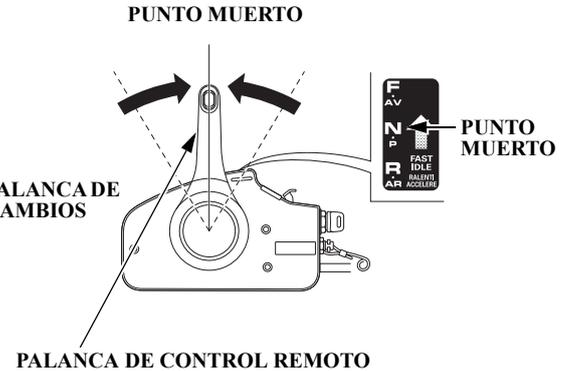
4. Ponga la palanca de cambios o la palanca de control remoto en la posición NEUTRAL (punto muerto).
