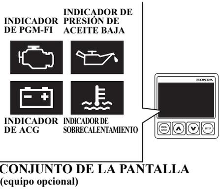
Si se reduce la presión del aceite de motor y/o se sobrecalienta el motor, puede activarse uno o ambos sistemas de advertencia.
