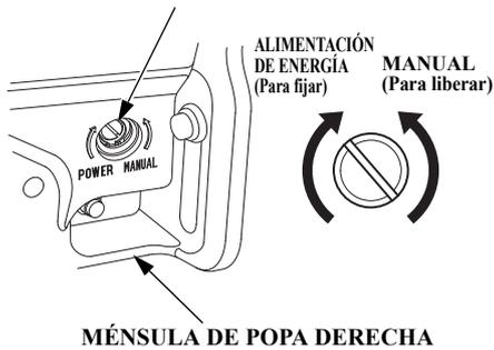
Cuando el sistema de trimado/inclinación motorizados no opera debido a que se ha descargado la batería o a una avería del motor de trimado/inclinación motorizados, podrá inclinar manualmente el motor fueraborda hacia arriba o abajo operando la válvula de descarga manual. Para inclinar manualmente el motor fueraborda, gire la válvula de alivio manual, de debajo de la ménsula de popa, tres vueltas y media hacia la izquierda empleando un destornillador.
