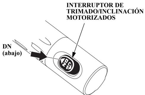
1. Presione la parte DN (abajo) del interruptor de trimado/inclinación motorizados y efectúe el trimado del motor fueraborda a la posición más baja.
