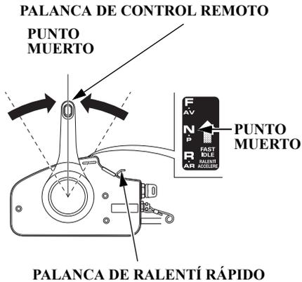
2. Coloque la palanca de control remoto en la posición de punto muerto. El motor no arranca a menos que la palanca de control remoto se encuentre en la posición de PUNTO MUERTO.
