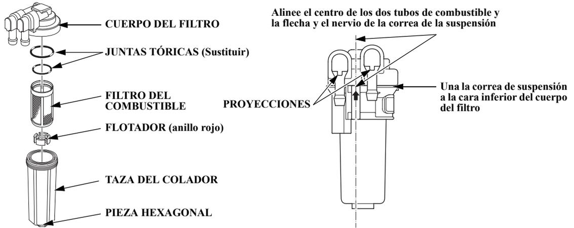
3. Gire la pieza hexagonal hacia la izquierda y separe la copela del cuerpo del filtro.
