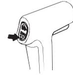
Con el motor fueraborda trimado alto, el medidor de trimado indicará tal como se muestra. Para bajar el casco, reduzca el ángulo de trimado del motor fueraborda presionando la parte DN (abajo) del interruptor de trimado/inclinación motorizados.
