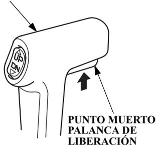
La palanca de liberación de punto muerto se ajusta en la palanca de control remoto para evitar el accionamiento accidental de la palanca de control remoto.
