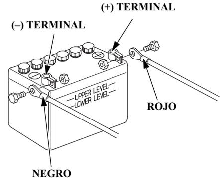
1. Desconecte el cable de a batería en el terminal negativo de la misma (-) y luego en el terminal positivo de la batería (+).
