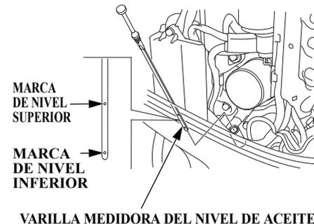
1. Ponga verticalmente el motor fueraborda, y extraiga la cubierta del motor.
