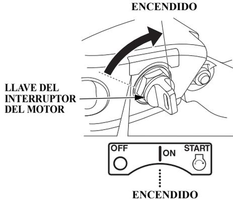
8. Gire la llave del interruptor del motor a la posición ON.
