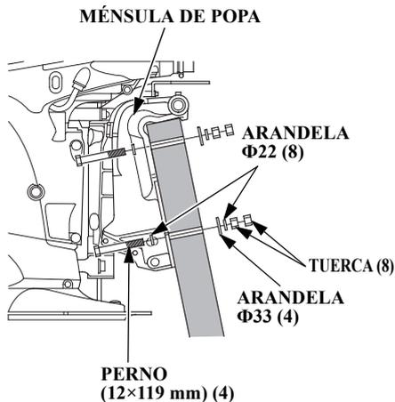
1. Aplique sellante de silicona (Three Bond 1216 o equivalente) a los orificios de fijación del motor fueraborda.
