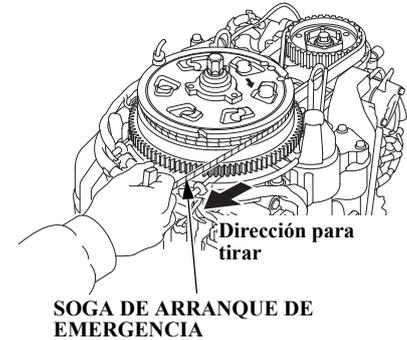
9. Tire ligeramente de la cuerda del arrancador de emergencia hasta notar resistencia, y entonces tire con fuerza en la dirección de la flecha como se muestra arriba.
