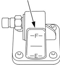
El indicador de combustible indica el nivel de combustible en el depósito.
