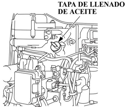
Cuando el aceite del motor está contaminado o descolorado, reemplace con aceite de motor nuevo (vea la página 86 para saber los intervalos y el método de sustitución).
