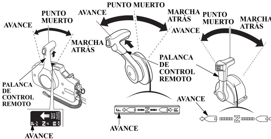
2. Mueva la palanca de control desde la posición de PUNTO MUERTO hacia la posición de AVANCE.
