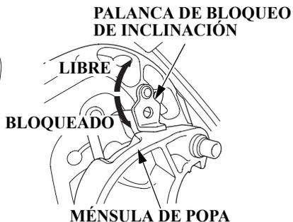
1. Levante el motor fueraborda todo lo posible empleando el interruptor de trimado/inclinación motorizados.
