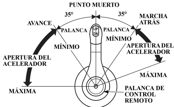
Cambiar a marcha adelante, marcha atrás o punto muerto y el ajuste de la velocidad del motor puede realizarse con la palanca de control remoto.
