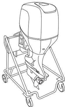
Transporte y guarde el motor fueraborda en posición vertical como se muestra arriba. Fije la ménsula de popa al soporte y fije el motor fueraborda con los pernos y las tuercas. Guarde el motor fueraborda en un lugar bien ventilado que no reciba la luz directa del sol y que no tenga humedad.
