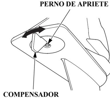
Si se gira la manija/timón de dirección hacia un lado mientras se navega a toda velocidad, ajuste el compensador para que la embarcación navegue hacia delante en línea recta.
