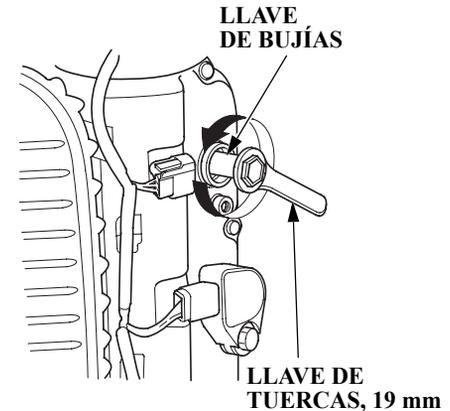
6. Utilice una llave de bujías y una llave de tuercas de 19 mm para extraer las bujías.
