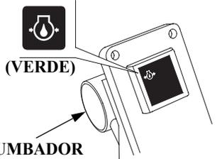
Se apaga el indicador de la presión de aceite y suena el zumbador cuando el nivel de aceite es bajo y/o el sistema de lubricación del motor está defectuoso. Entontes, la velocidad del motor se reduce gradualmente.
