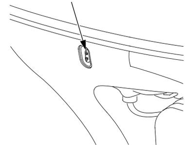
El interruptor de inclinación motorizada, situado en el cárter del motor fueraborda, es un práctico interruptor que permite inclinar el motor fueraborda para remolcarlo o para llevar a cabo su mantenimiento. Este interruptor de inclinación motorizada sólo deberá operarse cuando la embarcación esté parada y el motor desconectado.
