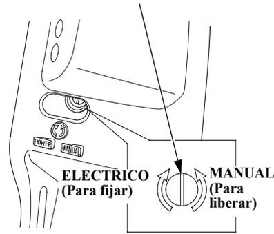
Cuando el sistema de trimado/inclinación motorizados no funciona debido a que la batería se ha agotado o a la avería del motor de trimado/inclinación, el motor fueraborda puede inclinarse manualmente hacia arriba o hacia abajo accionando la válvula de descarga manual.
