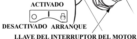
Este control remoto está equipado con un interruptor de encendido del tipo llave. En el tipo de montaje lateral (tipo R1), el interruptor del motor está situado a su lado cerca de la caja de control remoto. En el tipo de montaje en el panel (tipo R2) y tipo de montaje superior (tipo R3), el interruptor del motor está situado en el centro del panel de control.
