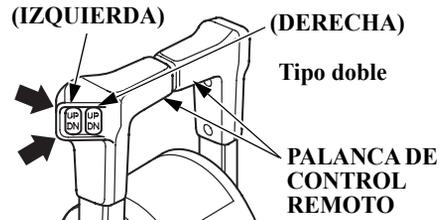
Presione la parte UP (arriba) o DN (abajo) del interruptor de trimado/inclinación motorizados e incline el motor fueraborda a la posición mejor de acuerdo con las condiciones de navegación.
