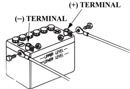
1. Desconecte el cable de a batería en el terminal negativo de la misma (-) y luego en el terminal positivo de la batería (+).
