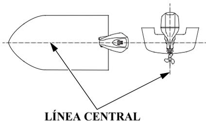
Instale el motor fueraborda en la popa, en la línea central de la embarcación.
