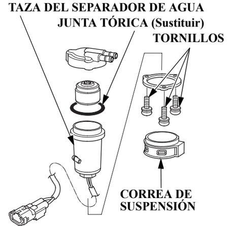
11. Extraiga los tres tornillos que sujetan el separador de agua, y elimine el agua o los sedimentos desde el interior de la taza.
