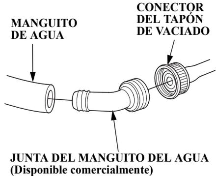
6. Conecte una manguera de agua potable a la junta de la manguera de agua.
