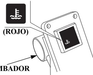
El indicador de sobrecalentamiento se enciende y suena el zumbador cuando el circuito de enfriamiento del motor está defectuoso. La velocidad del motor se reduce en tales circunstancias.
