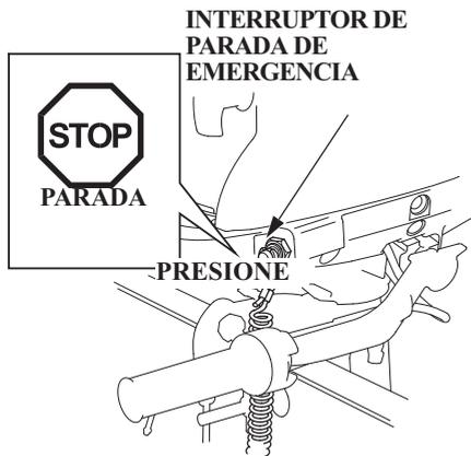
2. Presione el interruptor de parada de emergencia hasta que el motor se pare.
