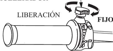
Utilice el pomo de fricción de la empuñadura del acelerador para mantener constante una cierta velocidad. Si se gira la perilla de fricción del acelerador en el sentido de las agujas del reloj, la empuñadura del acelerador se queda fija en su lugar; y si se gira la perilla de fricción de la empuñadura del acelerador en el sentido contrario al de las agujas del reloj.
