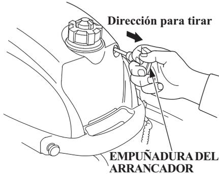
6. Tire ligeramente de la empuñadura del arrancador hasta notar resistencia, y entonces tire con fuerza en la dirección de la flecha como se muestra arriba.
