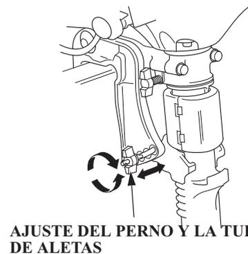
Emplee el perno de ajuste para ajustar el ángulo del motor fuera borda en la posición de funcionamiento normal. El ángulo del motor fuera borda se puede ajustar por los cuatro ángulos cambiando la posición del perno de ajuste.
