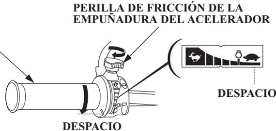
1. Para el tipo de palanca del acelerador: Mueva la palanca del acelerador a la posición **DESPACIO**.
