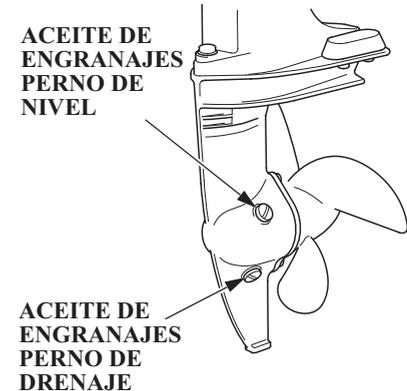
1. Ponga un recipiente adecuado debajo del orificio de drenaje de aceite para recibir el aceite usado, y extraiga entonces el perno del nivel de aceite y el perno de drenaje de aceite.
